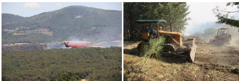
Figura XXX e XXX: esempi di attacco indiretto. A sinistra sgancio del canadair con ritardante, a destra intervento dei MMT per la realizzazione di una linea di sicurezza
