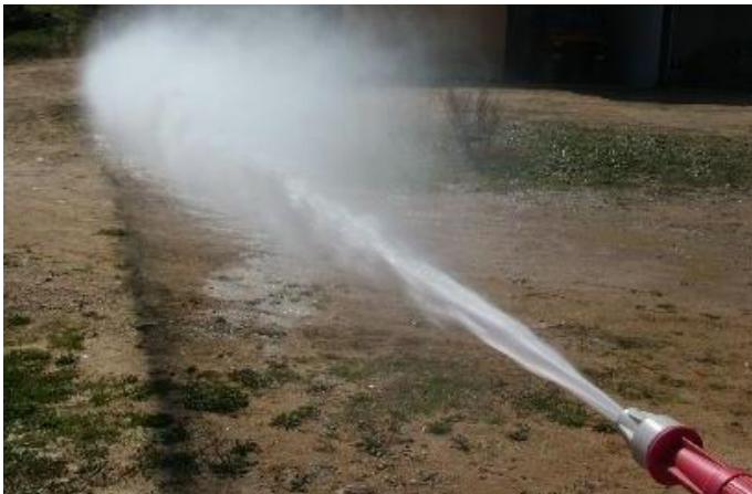
Immagine 22 - velocità di flusso di una lancia uni 45 ugello 10 mm portata 200 litri/min a 3 atm.
