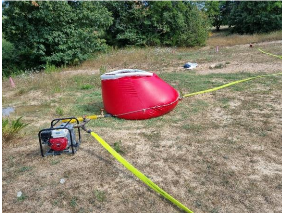
Immagine 47 - Linea d'acqua con utilizzo di motopompe per il rilancio.
