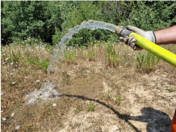
Immagine 20 - Velocità di flusso con manichetta UNI 45 e portata 200l/min. a 3 atm.
