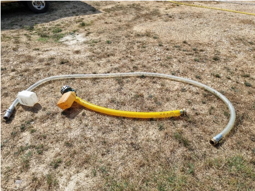
Immagine 31 - Tubazioni semirigide per l'aspirazione con succhieruola e galleggiante
