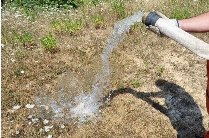
Immagine 21 - Velocità di flusso con manichetta UNI 70 e portata 200l/min. a 3 atm.
