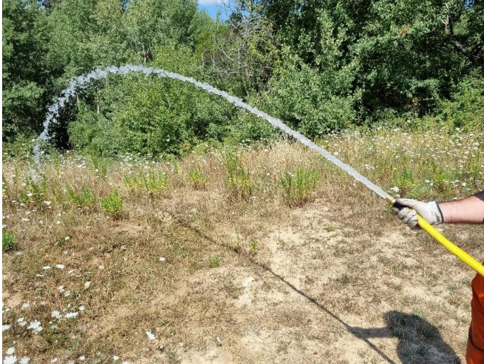
Immagine 19– Velocità di flusso con manichetta UNI 25 e portata 200l/min. a 3 atm.
